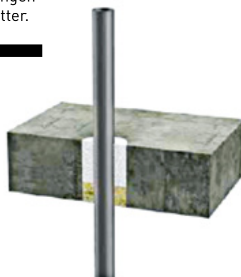
Eksempel på en typisk rørgjennomføring av mindre rør, hvor det ikke er behov for isolering av røret:
